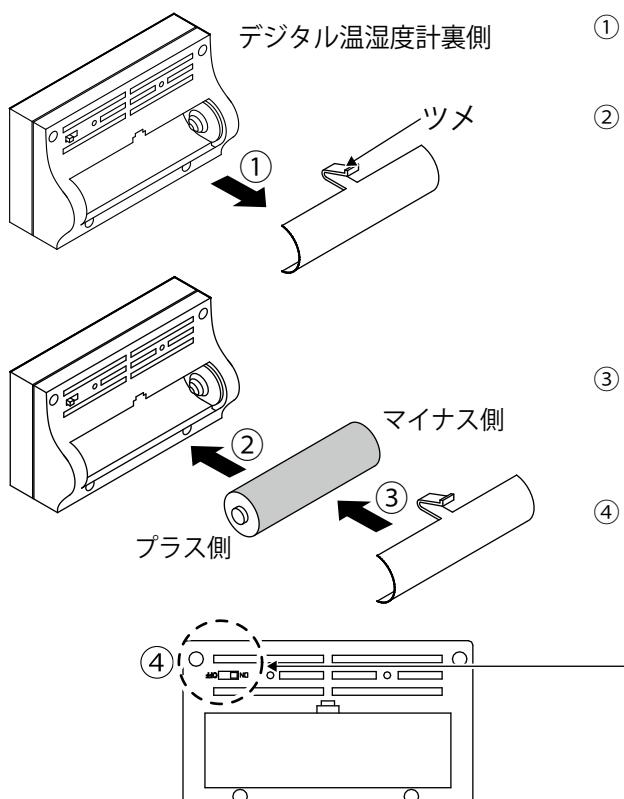
① デジタル温湿度計の裏側にある電池ボックスのフタ上側のツメを押し下げながら、フタを取り外します。
